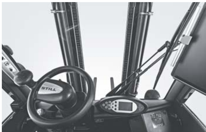
Visibilité optimale vers l'avant – mât à profil dégagé et planche de bord surbaissée
