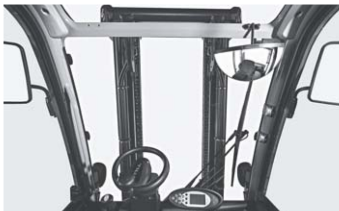
Profilés de mât étroits garantissant une visibilité maximale sur les fourches et la charge transportée
