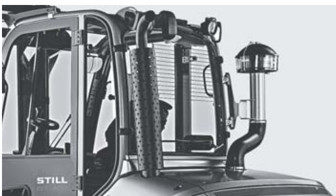
Filtre cyclonique purifiant l'admission d'air du moteur
