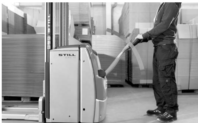
La sécurité de série : en fonction de la distance séparant l'opérateur du chariot, la vitesse s'adapte automatiquement à l'angle du timon
