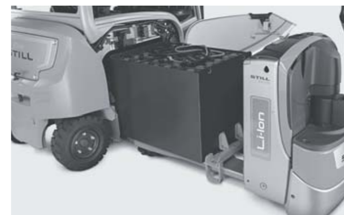
Changement de la batterie avec un chariot électrique
