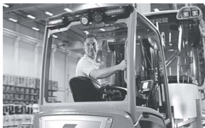
Siège pivotant avec visibilité vers l'arrière et saisie de la poignée
