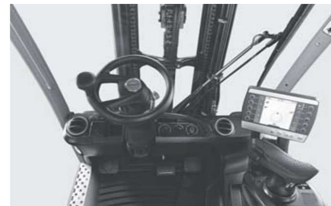
Poste de travail avec organes d'affichage et de commande, Joystick 4Plus et chauffage
